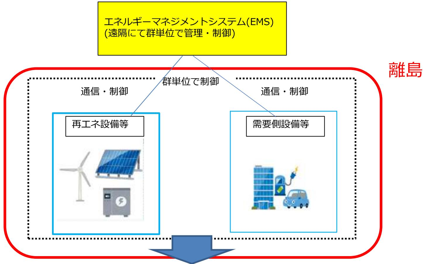
離島全体での調整力の強化により、再エネ自給率を向上するための設備の導入
